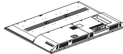
2 取り付け前に、スタンドの前部と後部を確認します。スタンドを底面のねじ穴に合わせ、付属のスタンド取り付けねじをスタンドのねじ穴に合わせます。プラスドライバーを使用して、スタンドを本製品に取り付けます。
