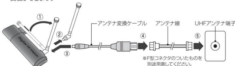
※アンテナ変換ケーブルを使用する場合、ロッドアンテナでの受信はできません。
